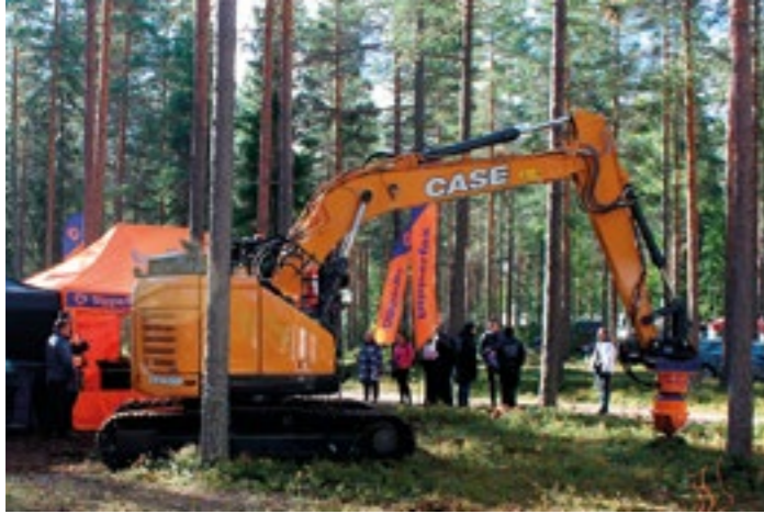
Dipperfox-kantojyrsin oli näyttävässä työnäytöksessä tela-alustaisessa Case CX145D koneessa.
