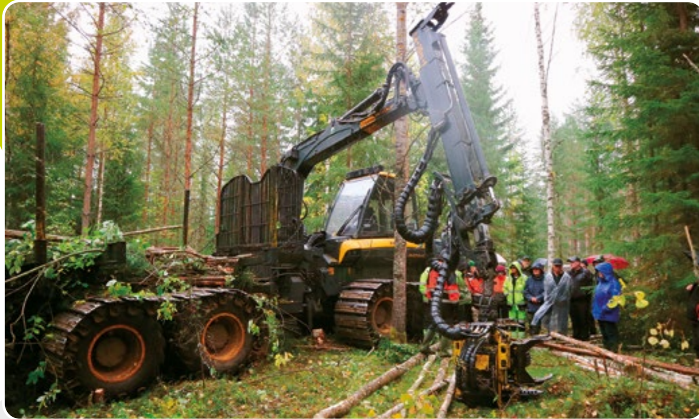
Giljotiinikouralla varustettu kombikone soveltuu hyvin energiapuun korjuuseen.
