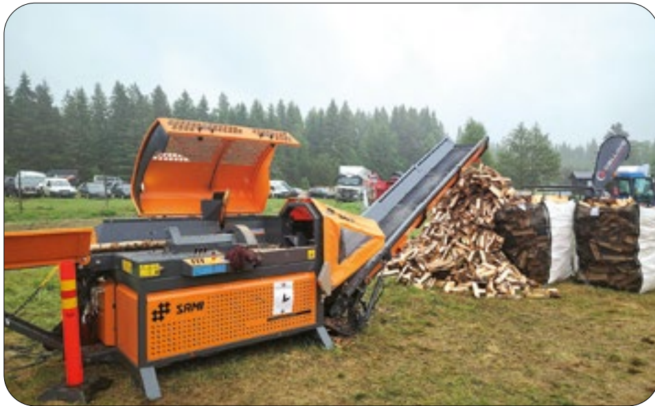
Sami Autochopper tallentaa lokiinsa sahattujen puiden mottimäärät.
