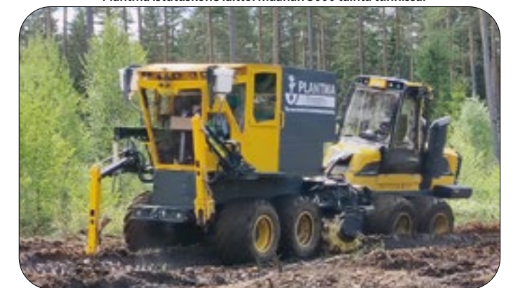
Logset Vaasasta esitteli messujen järeintä puunkorjuukalustoa. Plantma istutuskone laittoi maahan 3000 tainta tunnissa.
