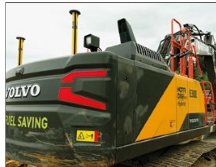
Järjestelmän painevaraajat, jotka on sijoitettu moottorin ja vastapainon väliin pidentävät hieman kaivukoneen ylävaunua, mutta tarvittavan suojauksen takia niihin ei juuri edes kiinnitä huomiota.
