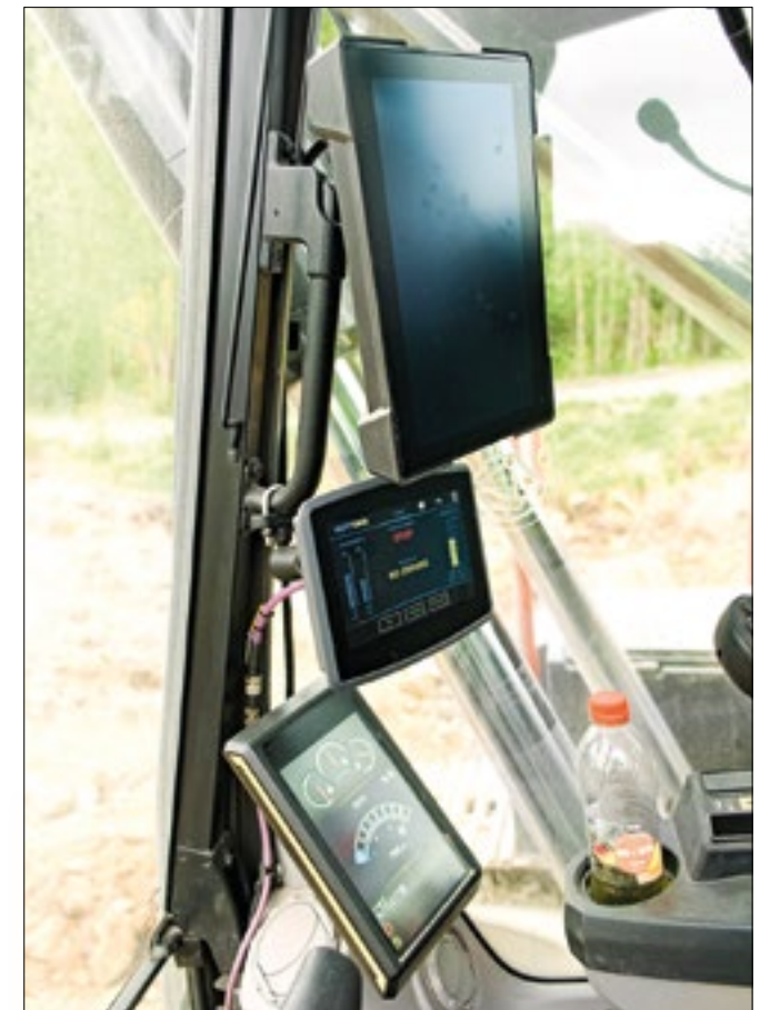
NorrDigi MCC-ohjausjärjestelmä lisää yhden ylimääräisen näytön (kesk.) ohjaamoon.
