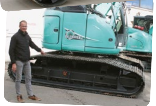
Konesilta Oy:n toimitusjohtaja Ville Kyllönen osoittaa kohtaa, josta KS-erikoisaluksen valmistuksessa koneen telarunkoa on jatkettu 30 cm.
