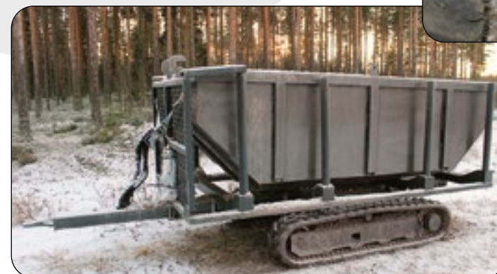
Maansiirtoperävaunussa on telat, jolloin kuorma kulkee pehmeässäkin paikassa.
