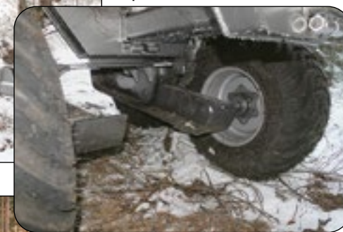
Metsäperävaunun telessä on pehmeällä maalla kantavuutta parantavat sukat.
