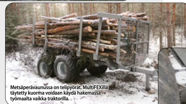
Koneen perässä on kuorma-auton vetolaitte perävaunuja varten. Perään saadaan joko metsäperävaunu tai maansiirtoperävaunu.
