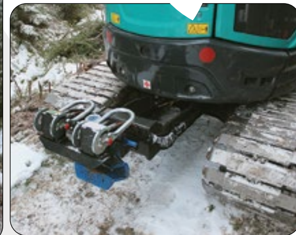
Koneen perässä on kuorma-auton vetolaitte perävaunuja varten. Perään saadaan joko metsäperävaunu tai maansiirtoperävaunu.
