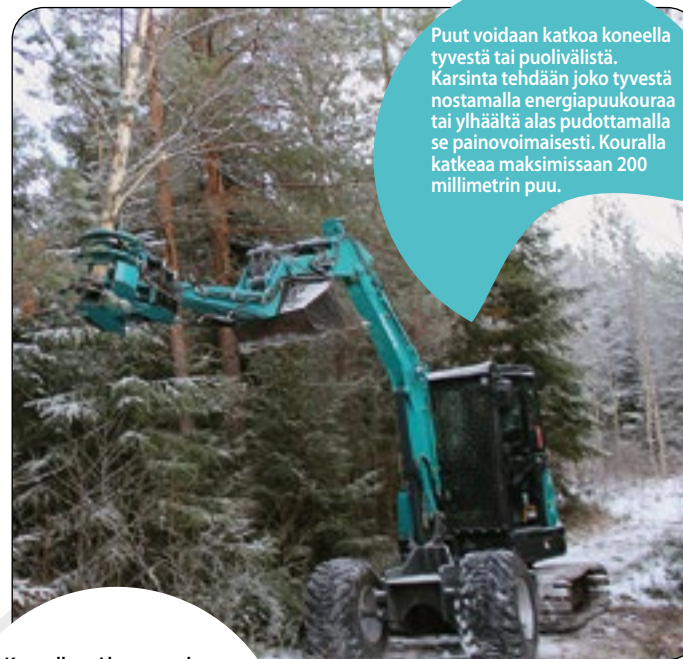
Koneella voi harvennuksen ohessa tasata tietä, poistaa kantoja tai vaikka kaivaa ojaa. Kaivukonekäytössä kaatopää lukitaan yläasentoon.
