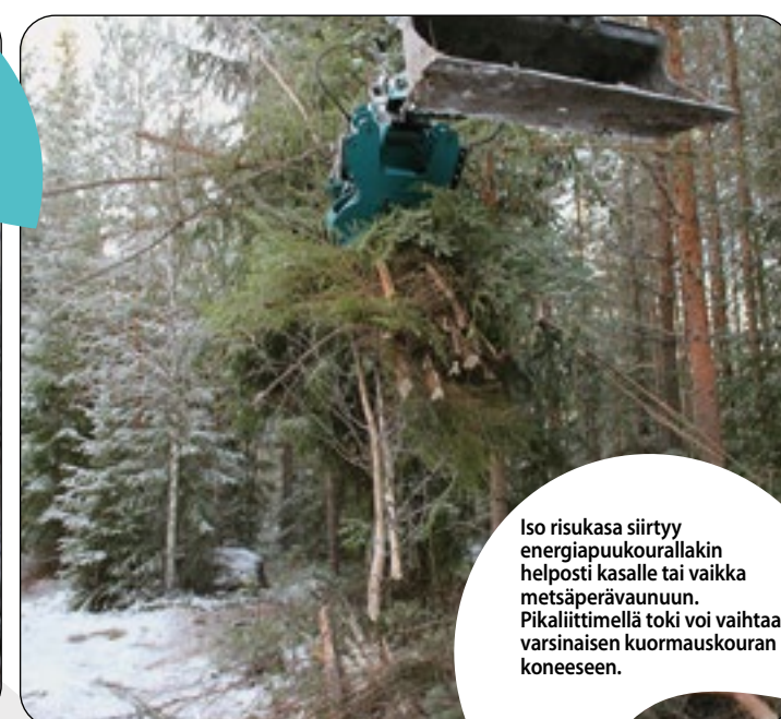
Puut voidaan katkoa koneella tyvestä tai puoliväliltä. Karsinta tehdään joko tyvestä nostamalla energiapuukouraa tai ylhäältä alas pudottamalla se painovoimaisesti. Kouralla katkeaa maksimissaan 200 millimetrin puu.
