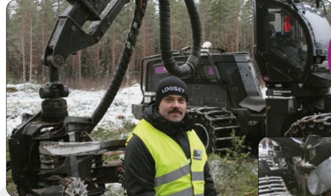
Logsetin uusi nosturi Logset H 245 työnäytöksessä. Nosturissa ei ole puomin päällä mitään sylinteriä eikä muutakaan rikkuvaa. Sylinterit ovat puomin alapuolella.
