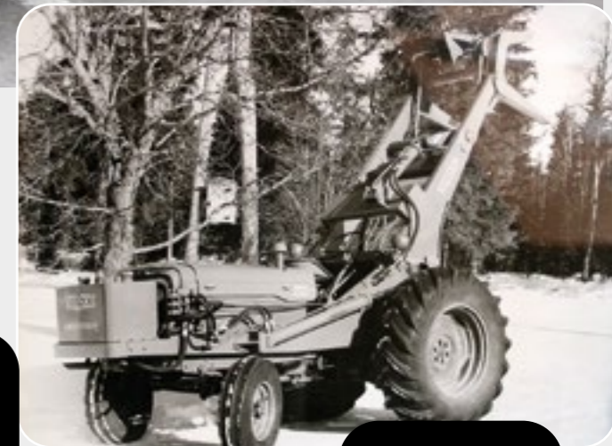
VILSKE pyöräkuormaaja, joka on tehty traktorin rungolle. Kuva Wille Machines Oy
