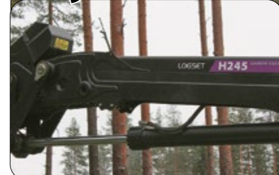
Uudessa Logset H 245 nosturissa on myös Smooth Crane ominaisuus, jolla anturien avulla saadaan pehmeät nosturin liikkeet. Yllettimessä on uusi laseranturointi.
