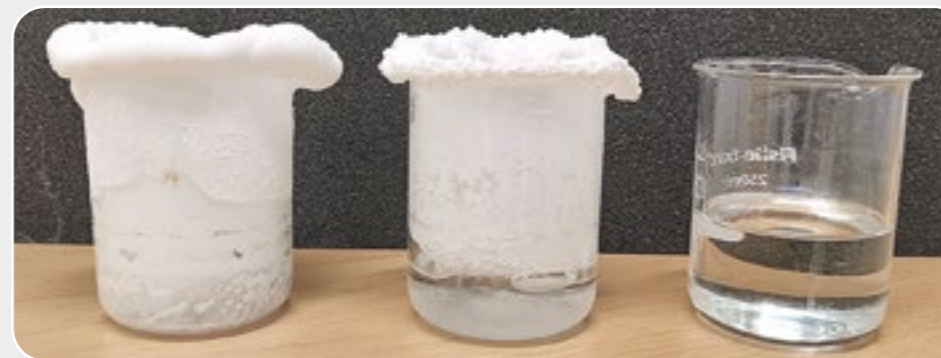
Myös korkeita lämpötiloja Defrosta kestää kiteytymättä, toisin kuin oikealla oleva perinteinen urealiuos.
