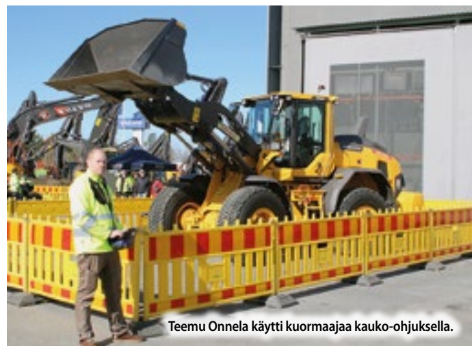
Konepellin alla onkin akusto. Koneessa on kaksi sähkömoottoria. Toinen käyttää hydraulikkapumppuja ja toinen vaihteistoa.
