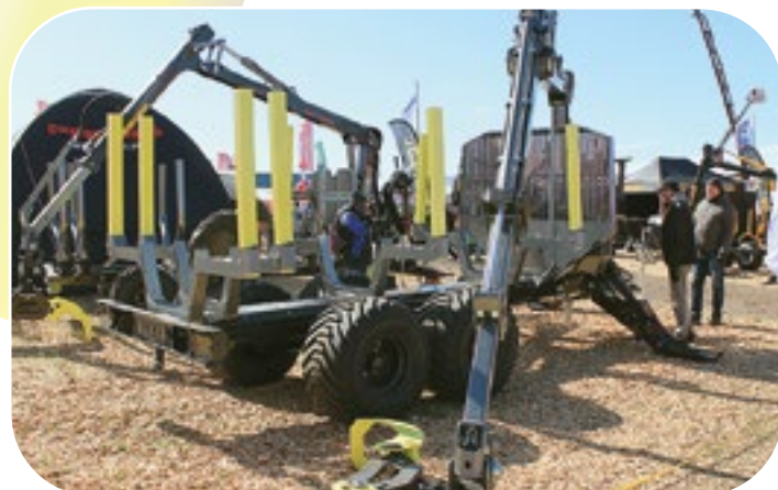
Järeä Palms metsäperävaunu 10UX. Oma paino on 2270 kiloa ja kokonaispaino kuormalla 13000 kiloa.
