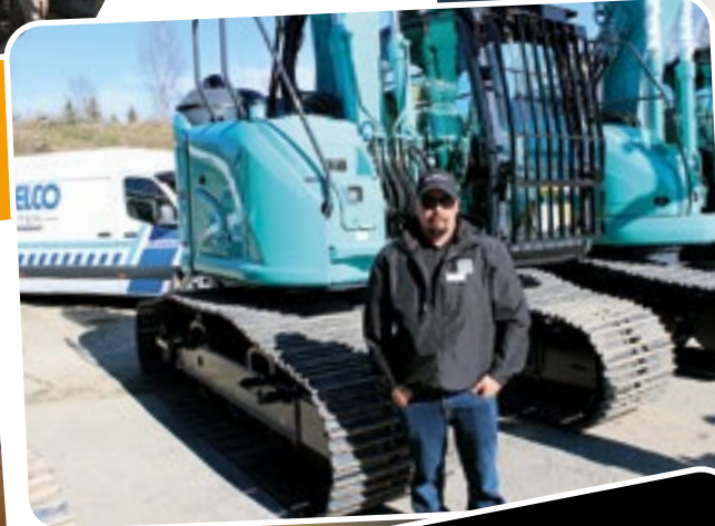
Uutta Kobelco SR165LC-7 metsälustalla varustettua kaivukonetta esitteli KH-Koneiden Toni Vääntinen. Koneessa on isommat ajomoottorit ja paremmat suojaukset. Koneen paino on noin 18 tonnia ja moottorin teho noin 86 kilowattia.
