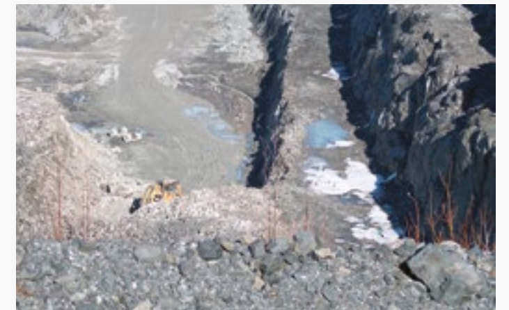
Kuvan kaivukone on yli 100 metrin syvyydessä ja painaa 300 tonnia.
