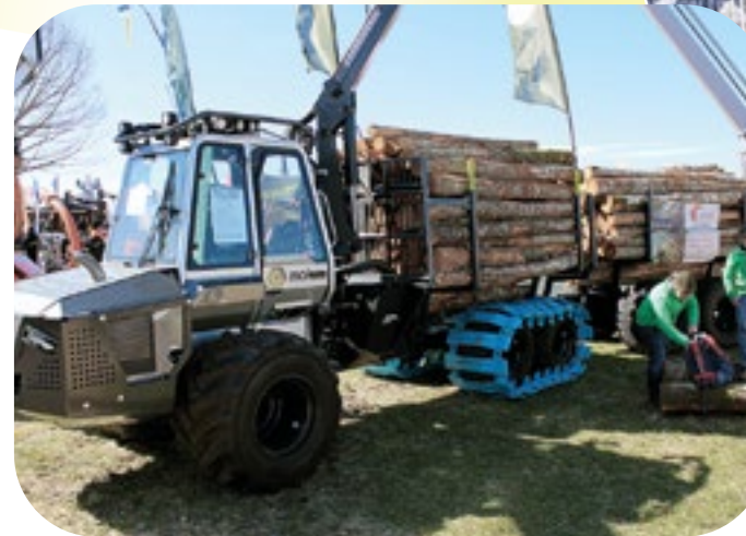
Malwa 560.5F ajokone oli varustettu perävaunulla. Puuta tulee metsästä pois perävaunun kanssa lähes tuplamäärä. Moottori on 55 kilowattinen Caterpillar.
