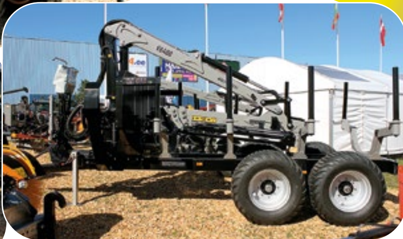
Multiforest MF1202 metsäperävaunu ja V8400 nosturi. Kokonaispaino kuorman kanssa on 12000 kiloa.
